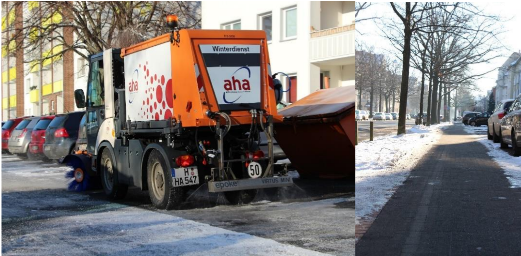
Bild: Intensives Kehren der Radwege mit anschließender Aufbringung minimaler Mengen an Salzlösung erzeugt optimale Fahrverhältnisse ohne wesentliche Umweltbelastungen; C:aha Hannover
